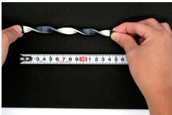
塗装した天然ゴムをひねった様子。塗装のひび、割れ、剥離、変色がない
